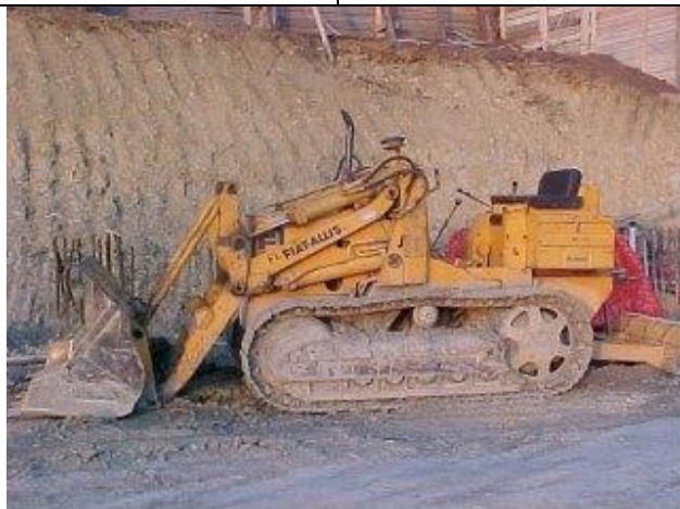
Pala cingolata di vecchio tipo sprovvista di telaio antiribaltamento
